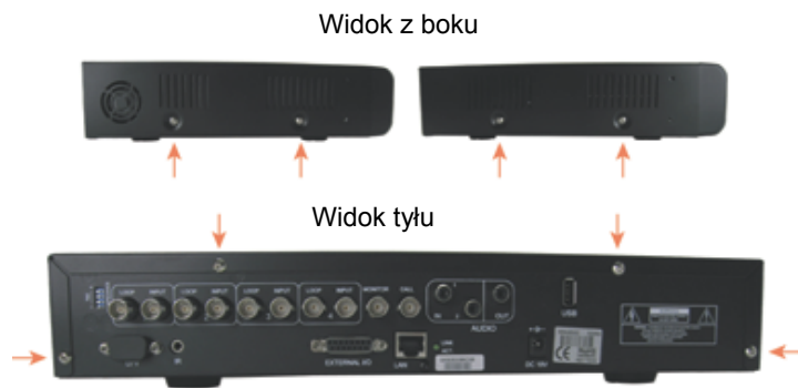
KROK 1-1. Odkręcanie śrub
